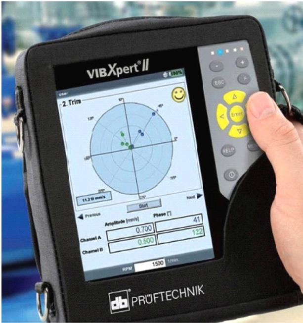
德国 PRUFTECHNIK 公司生产的该款仪器，可用于机床、汽轮机、风机、离心机、水轮机、水泵等所有旋转机械的柔性及刚性转子现场单/双面动平衡。
