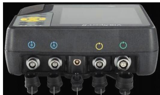
测量通道 A & B      温度      触法/转速
